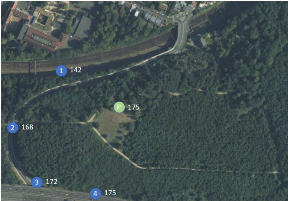
Topographie simplifiée à proximité de l'ouvrage : niveaux NGF des différents points d'intérêt (source : Géoportail)
